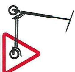
**Kleine Rollen** und die **ungleichmäßige Gewichtsverteilung** durch den Schulranzen können die Stabilität und Sicherheit beim Fahren einschränken. Insbesondere beim Überqueren von Bodennebenheiten oder Schienen besteht ein erhöhtes **Sturzrisiko**.
